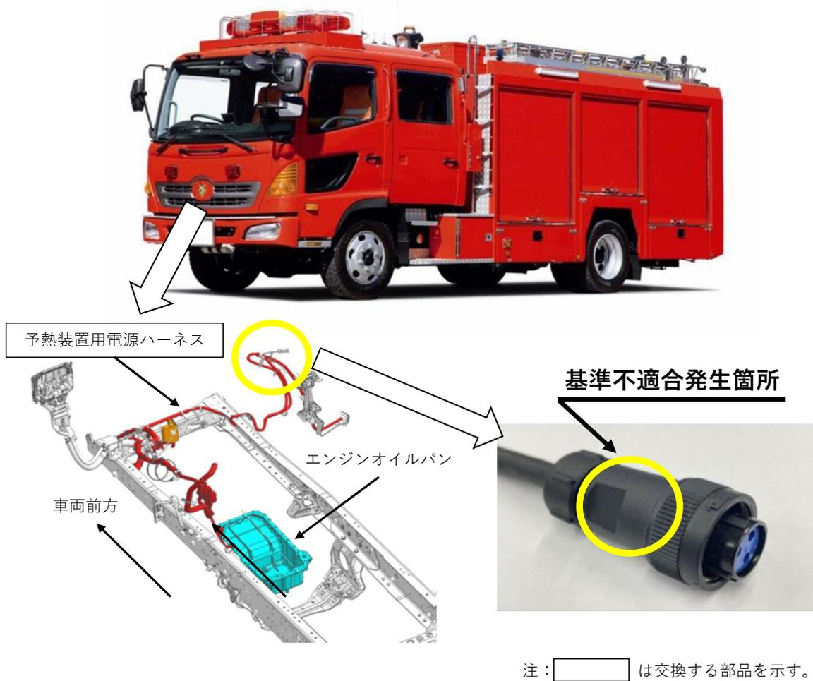
エンジンオイルの予熱装置用電源ハーネスにおいて、作業指示が不十分だったため、端子の絶縁処理が適切に行われていないものがある。
